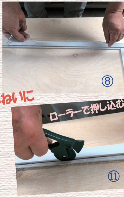
⑪ 念のためワンタッチローラーで再度押さえゴムをていねいに押さえ込みます。
